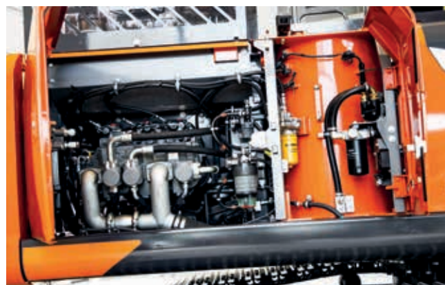
Úspora spotřeby paliva až 10% je dosažena díky hydraulickému systému TRIAS III.
