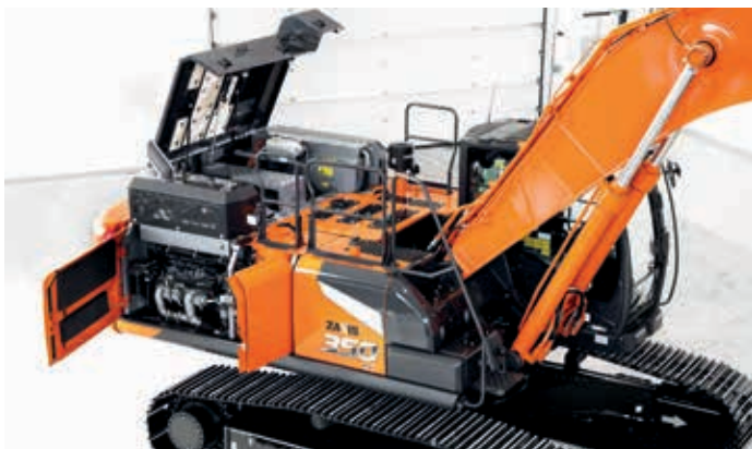
Kryt motoru s tlumiči (ZX300 / ZX350) umožňuje pohodlný přístup k provádění denních prohlídek.
