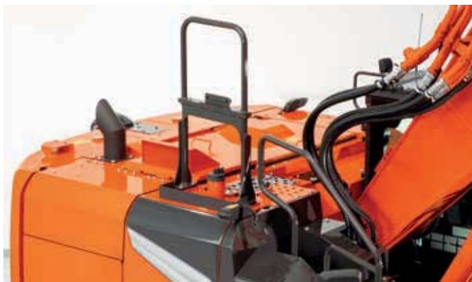
Nové zábradlí na modelu ZX225US/USR-7 je pro snazší přepravu zasouvateľné.
