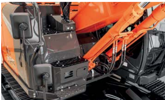
Široké schody na ZX225US/USR-7 umožňují snadnější údržbu.
