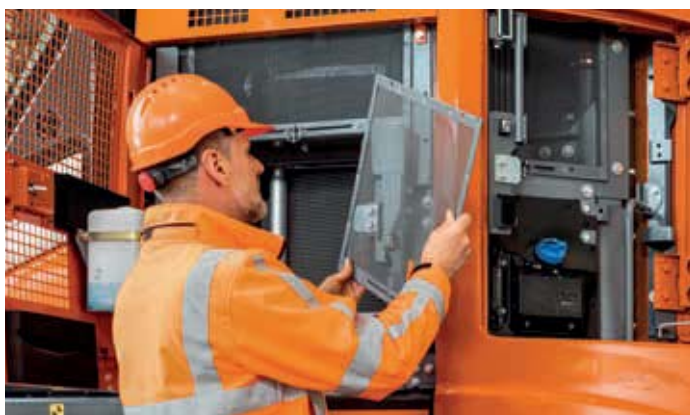
Údržba se snadno provádí přímo ze země.
