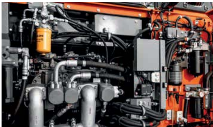
Nové uspořádání zaručuje pohodlný přístup ke všem filtrům.
