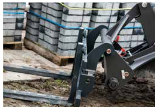
Bezpečné a snadné osazování pracovního příslušenství pomocí rychlospojky.
