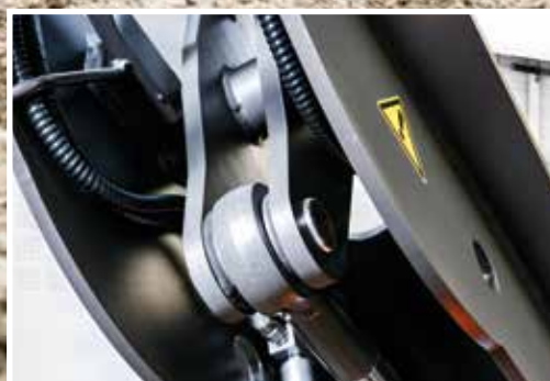
Vnitřní vedení hadic a kabelů chrání důležité komponenty.
