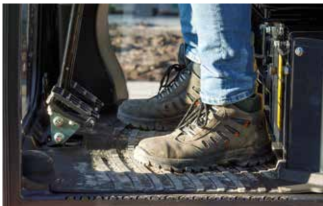
Sklopné pojezdové pedály mohou být použity namísto ruční ovládací páky.
