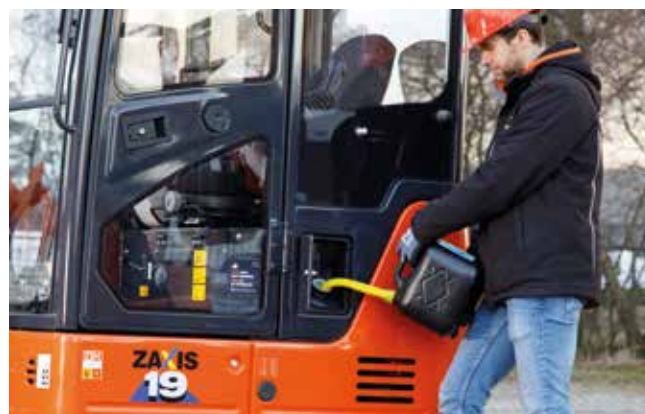
Přemístěné plnicí hrdlo palivové nádrže umožňuje snadno doplňování paliva.
