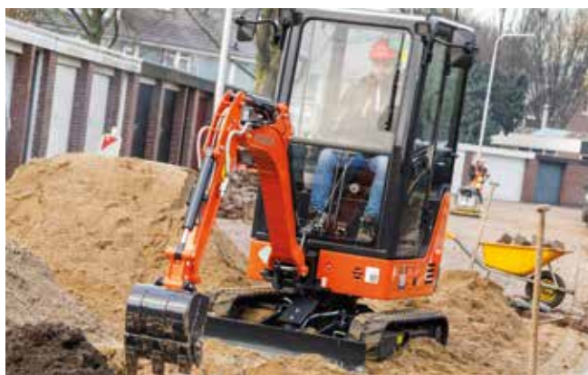
Hydraulická hadice na předním předávném zařízení je umístěna uvnitř výložníku pro zvýšení míry ochrany.
