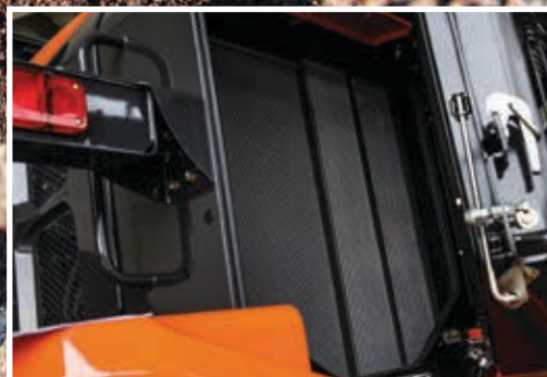
Volitelné chladiče s ochranou proti ucpávání posilují odolnost.
