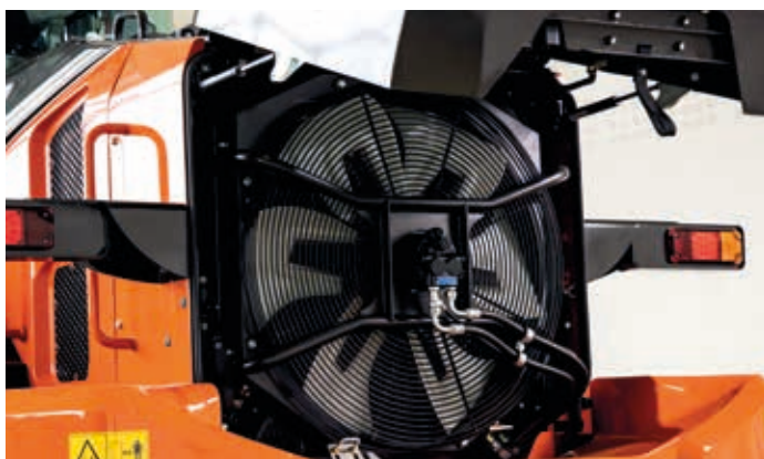
Inteligentní systém ovládání ventilátoru zabraňuje ucpávání chladiče motoru.
