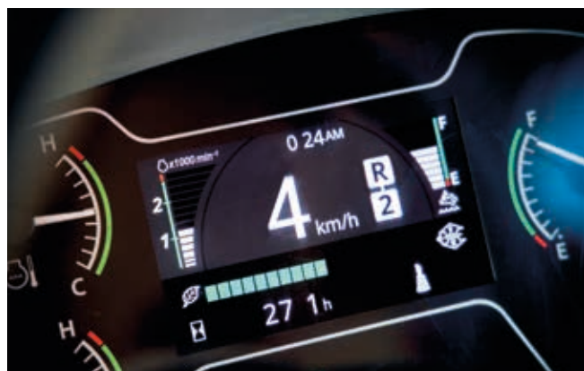
Indikátor režimu ECO pomáhá dosáhnout nižší spotřeby paliva.
