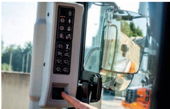
Elektricky ovládaná zrcátka poskytují nerušený zadní výhled.
