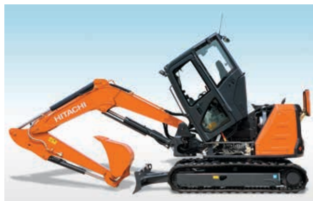
Naklápěcí podlaha usnadňuje přístup k motoru a řídicímu ventilu pro rychlou údržbu.
