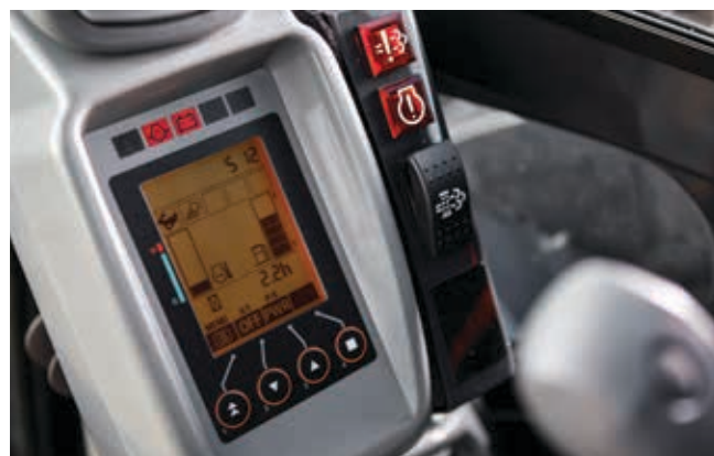
Multifunkční LCD monitor zobrazuje data přehledným způsobem.
