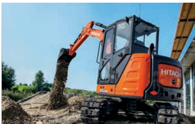
Poloměr otáčení krátké zádě stroje ZX65USB-6 je ideální pro práci ve stísněných prostorách.
